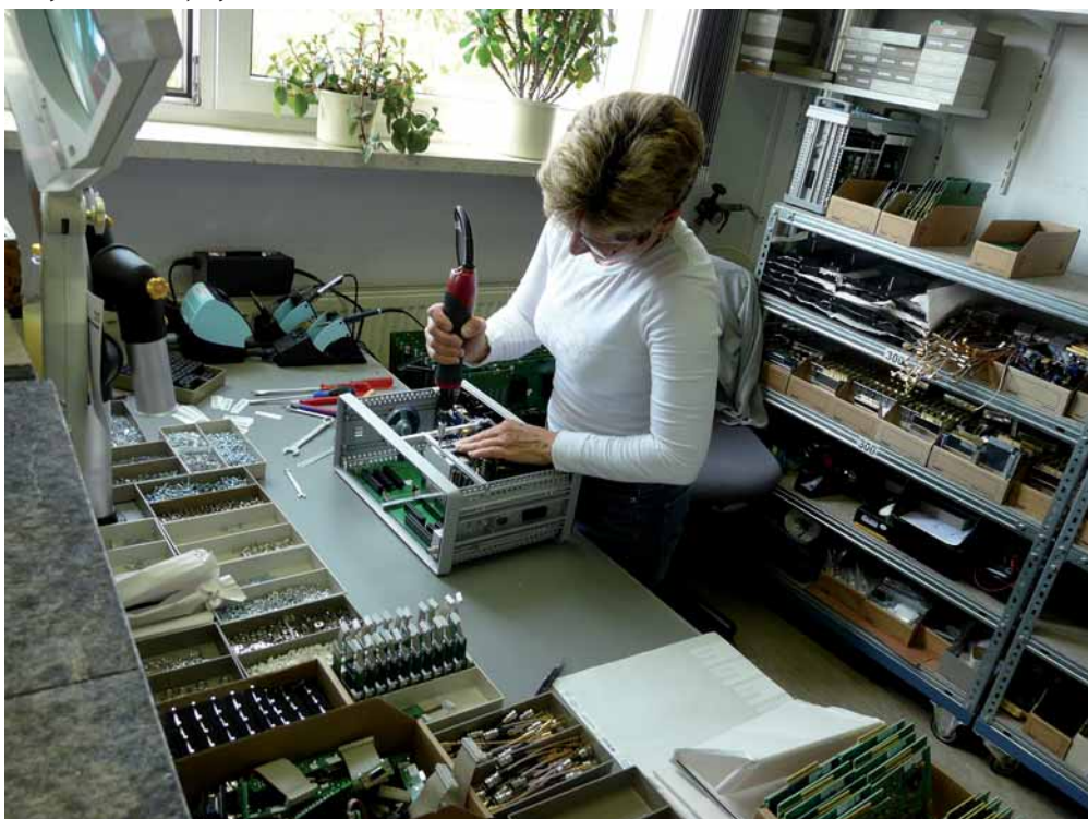
Montage der KWS-Mesempfangern im Betrieb in Tattenhausen
